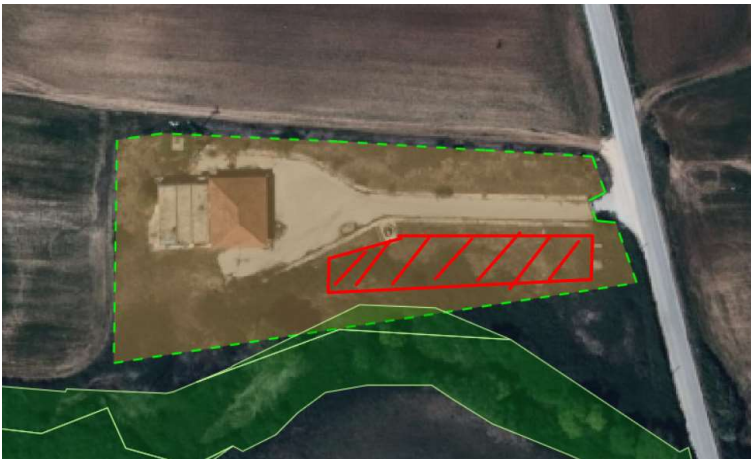
Εικόνα 6 Γήπεδο εγκατάστασης αντλιοστασίου με διαθέσιμο χώρο για επεμβάσεις.
